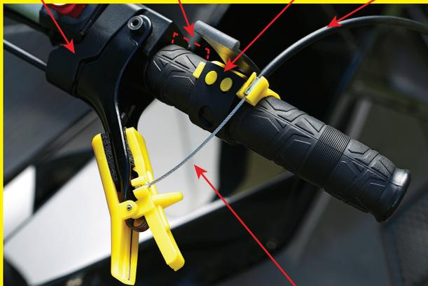
Le câble doit être en ligne droite
